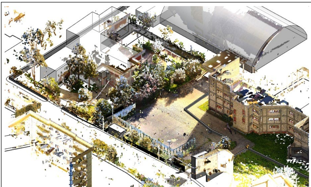
Figura 3 – Restituzione in ambiente BIM della nuvola di punti
